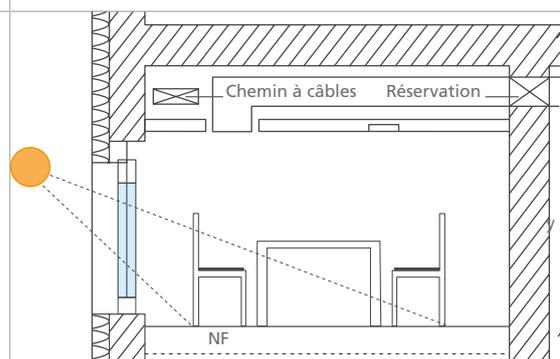
Détail de la façade, calepinage, fenêtre, surchauffe, principe d'éclairage, surfaces de ventilation nocturne, éclairage naturel. Intégration des réservations.
