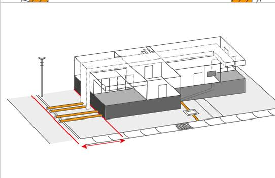
Dessin des réseaux d'évacuation extérieurs (du point de vue de l'IGC jusqu'à la frontière du terrain), définition des couches inférieures
