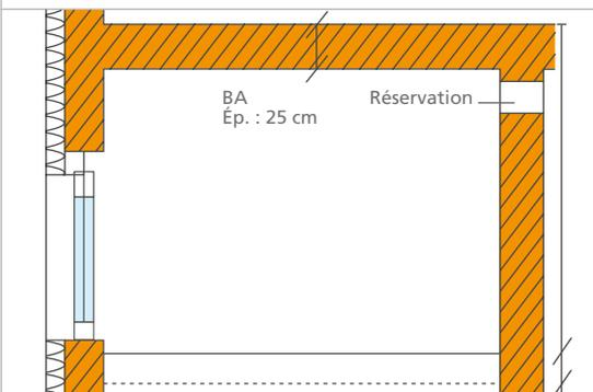
Dessin des éléments porteurs dimensionnés avec précision du matériau (qualité de béton, etc.) Intégration des réservations dans la structure portante
