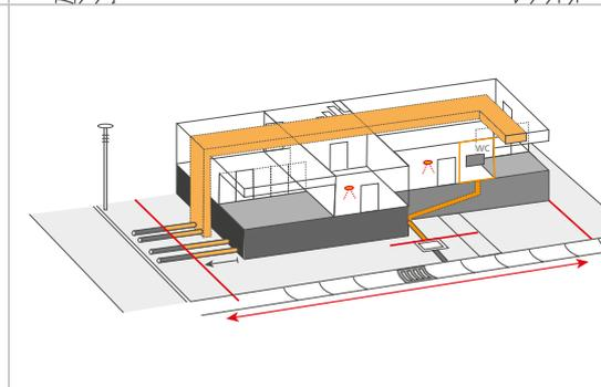
Position des impétrants (> 1m à l'extérieur du bâtiment), éclairage extérieurs
