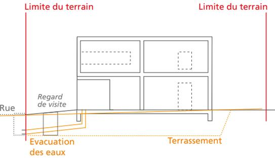
Dessin des réseaux d'évacuation extérieurs (du point de vue de l'IGC jusqu'à la frontière du terrain) + plans de terrassement + plans de voiries.
