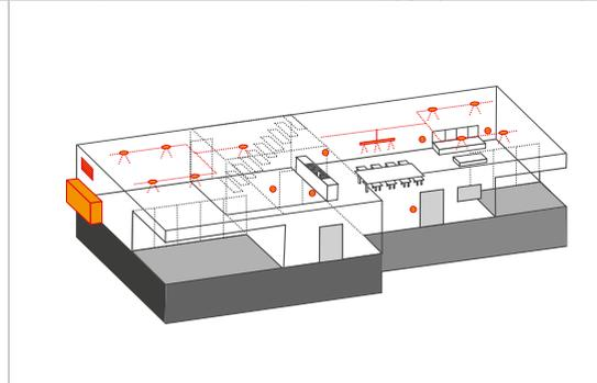
Tracés des réseaux par tech. avec élts visibles (Eclairages, prises, bouches...) Précision du diam. à l'écrit (ex. DN100), définition et gabarit des équipements de production (chaudière, ventilation,...), demandes de réservations.
