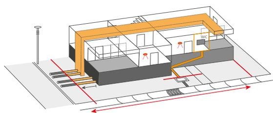
Dessin des impétrants (> 1m à l'extérieur du bâtiment), éclairage extérieurs + détails d'exécution
