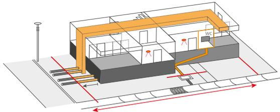
Position des impétrants (> 1m à l'extérieur du bâtiment), éclairage extérieurs
