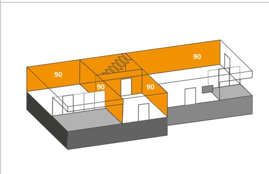
Indication de la résistance au feu par éléments de construction porteurs
