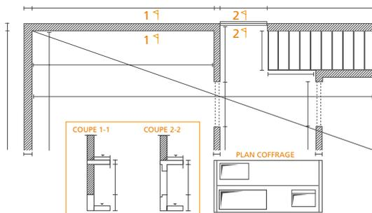
Dessin des éléments porteurs dimensionnés avec précision du matériau (qualité de béton, etc.), intégration des réservations, plans de ferrailage et de coffrage + plans de socle pour équipements
