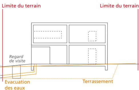
Dessin des réseaux d'évacuation extérieurs (du point de vue de l'IGC jusqu'à la frontière du terrain) + plans de terrassement
