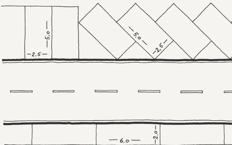
Figure 6 : dimensionnement des emplacements pour voitures
