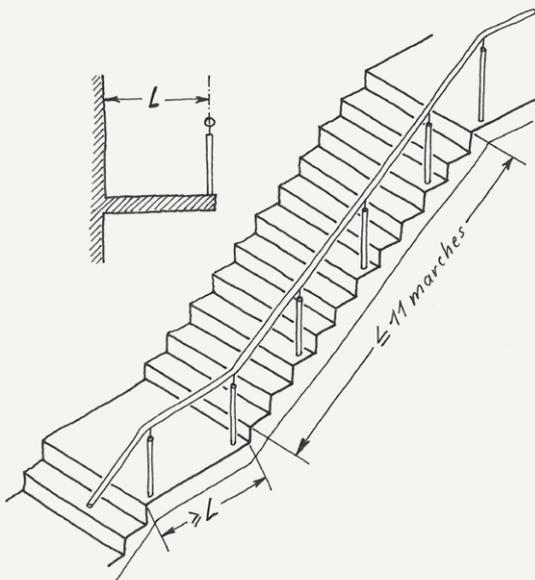
Figure 12 : géométrie d'un escalier
